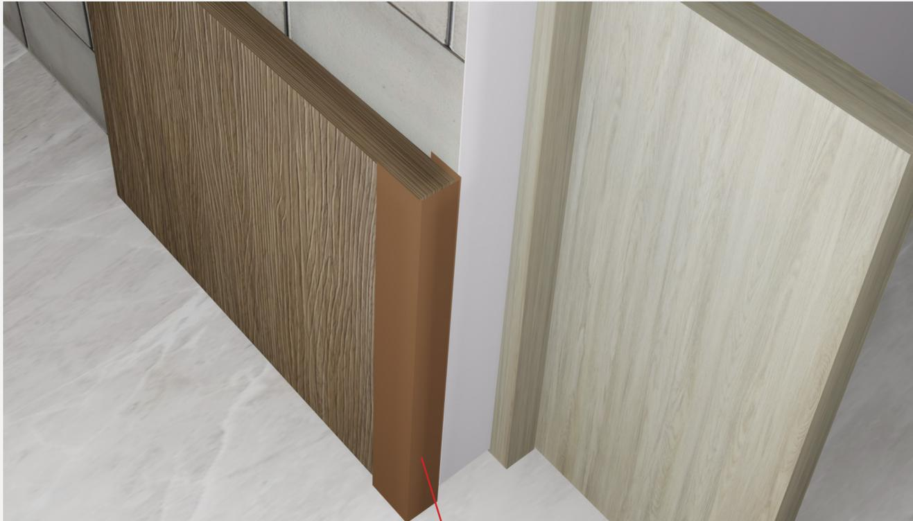
Примыкание к оконным проемам монтируются аналогичным способом, с помощью L-профиля
